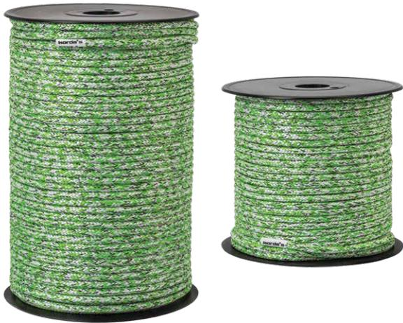
Cordino de dyneema de 5,5mm, muy flexible y ligero. Gracias a la funda de dyneema, ofrece una alta resistencia a la abrasión, y una baja elongación. Adecuada para múltiples aplicaciones donde no se exige una absorción de energía.
